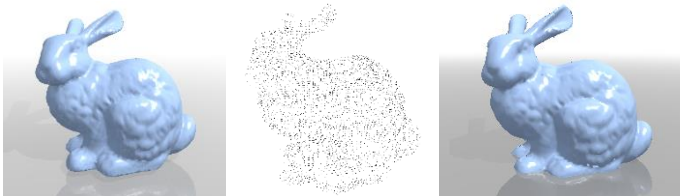
그림 1: (좌) 삼각형 모델을 전역조명 렌더링한 결과, (중간) 36K개의 점집합 모델, (우) 이동 최소 자승법으로 근사된 표면에 전역 조명에 의한 그림자 효과와 반사 효과를 적용하여 점 집합 모델을 렌더링 결과이다.
